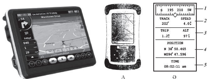
8.17 сурет. GPS қабылдағыштың сыртқы көрінісі (а) мен беті (ә):
