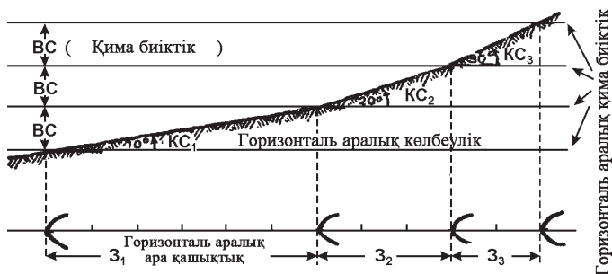
9.4-сурет. Қима биіктігі бірдей болған жағдайда беткейдің көлбеулігімен горизонталь аралық ұзындықтың мәнінің арасындағы байланыс
