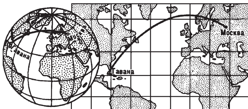
2.1-сурет. Мәскеу мен Гаванна қалаларының аралығының глобустағы және картаға көшірілген ортодромясы (үшкен шеңбердің доғасы)
